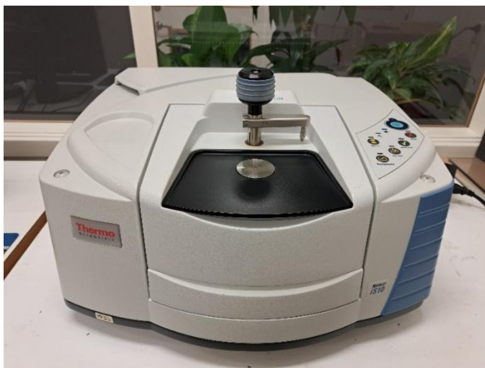
Figur 5 VTI:s FTIR-apparat med ATR. Foto: Jiqing Zhu.
