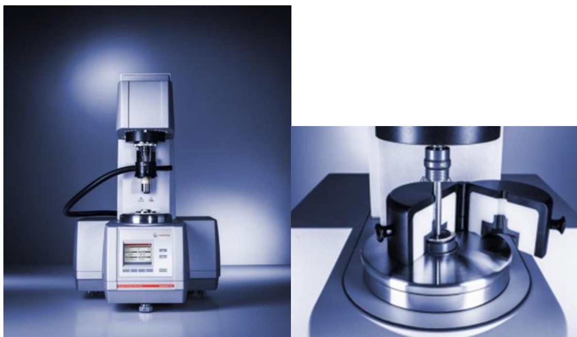
Figur 6 Exempel på DSR-utrustning (Källa: Anton Paar)
